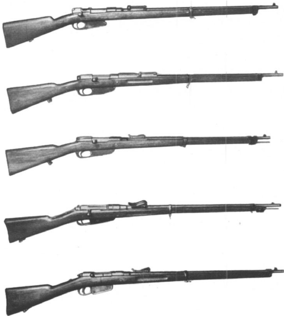
Fucili sperimentali studiati per l'adozione del fucile italiano di piccolo calibro. Dall'alto: Mauser N° 2 calibro 6,5, alzo a ritto con cursore; Mauser a ripetizione sistema Mannlicher, calibro 6,5; Mauser - Mannlicher Terni tipo 2 bis modello 93, calibro 6,5; fucile italiano tipo N° 1 bis a caricamento multiplo sistema Mannlicher; fucile 1891 N' 2, caricamento multiplo sistema Mannlicher, rigatura progressiva calibro 6,5.
