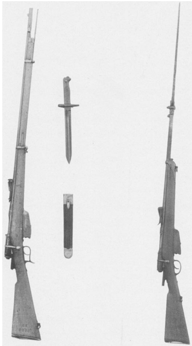
A sinistra, fucile Vetterli modello 1870-87/1915 con sciabola-baionetta accorciata. A destra, moschetto Vetterli modello 1870-87-1915 da carabinieri con la baionetta inastata. Si notino le scatole-serbatoio tipo 91.
