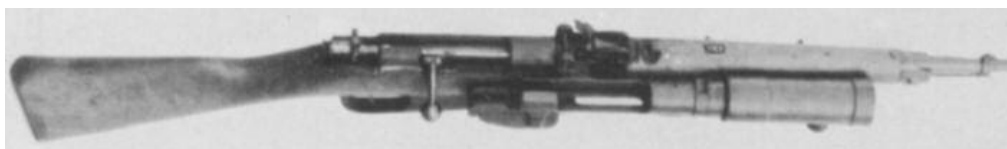
Tromboncino modello 1928 annesso al moschetto modello 91 TS modificato. Si noti la culatta simile a quella del moschetto.
